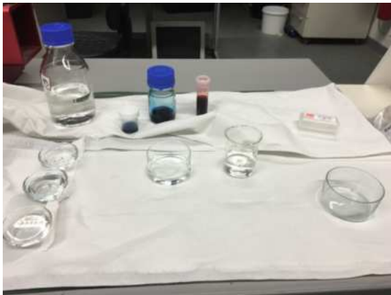
Abbildung 17 Zeigt die benötigten Utensilien die zum Färben der Schnitte notwendig waren. Ethanol, Astrablau, Safranin und destilliertes Wasser waren die wesentlichen Komponenten
