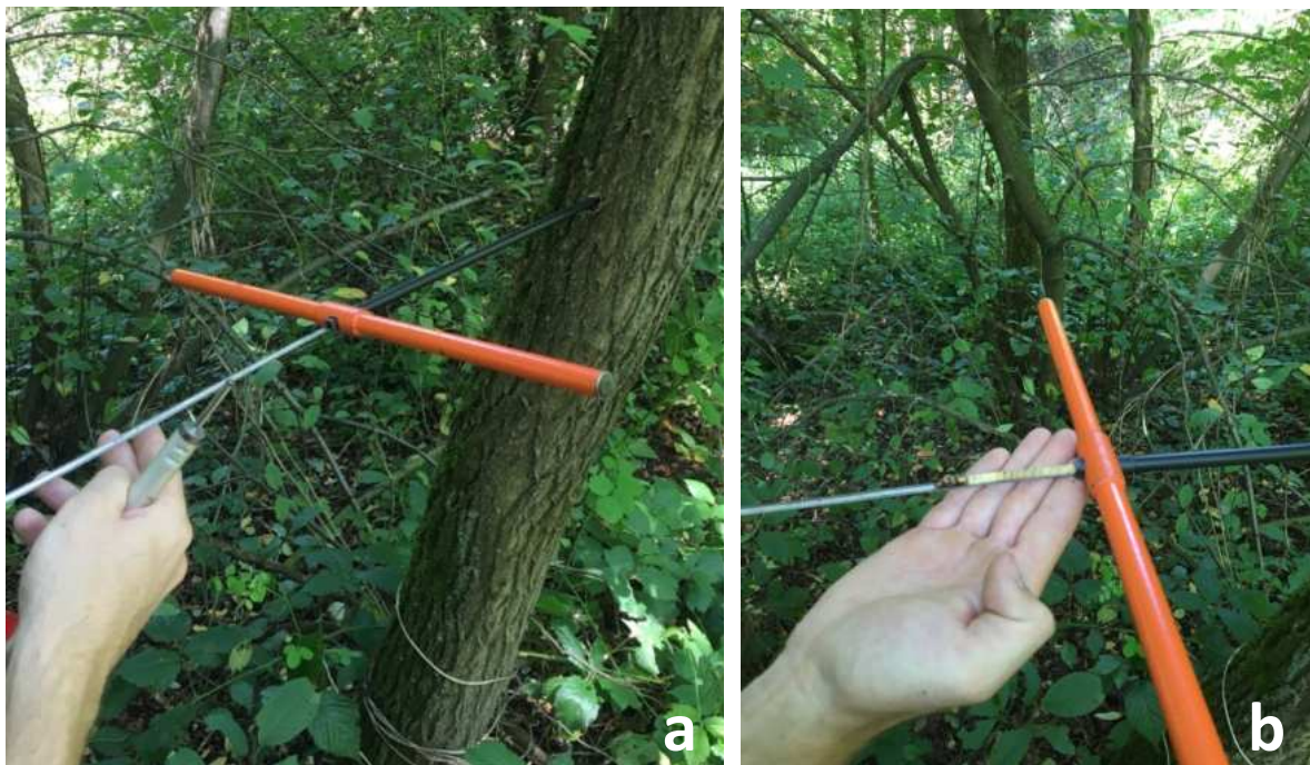
Abbildung 11 a: Der Zuwachsbohrer im Einsatz; b: Der Bohrkern wird aus dem Zuwachsbohrer gezogen
