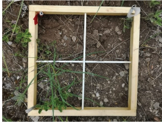
Abb. 4: 20x20cm Holzrahmen zur Datenaufnahme mit Metallstäben im Boden zur besseren Auffindbarkeit.
