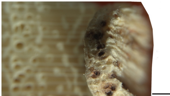
Abbildung 47 Rostrote Verfärbungen der Gefäße des letzten Jahrringes, Maßbalken= 1 mm
