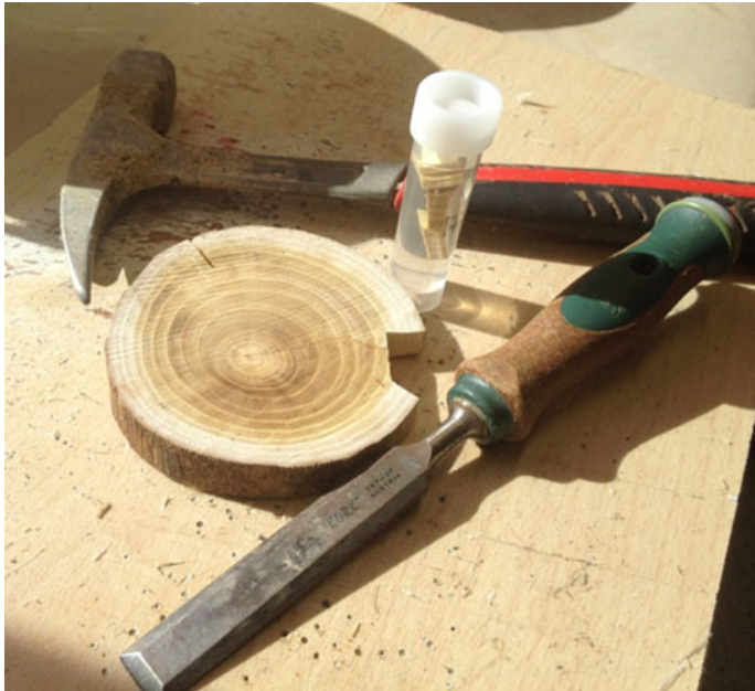
Abbildung 14 Probenvorbereitung: Eine ca. 1,5 cm dicke Holzscheibe sowie Hammer und Stemmeisen zur Gewinnung der benötigten Holzkeile. Zusätzlich ist ein Plastikbehälter abgebildet, der bereits eine in Wasser eingelegte Holzprobe enthält
