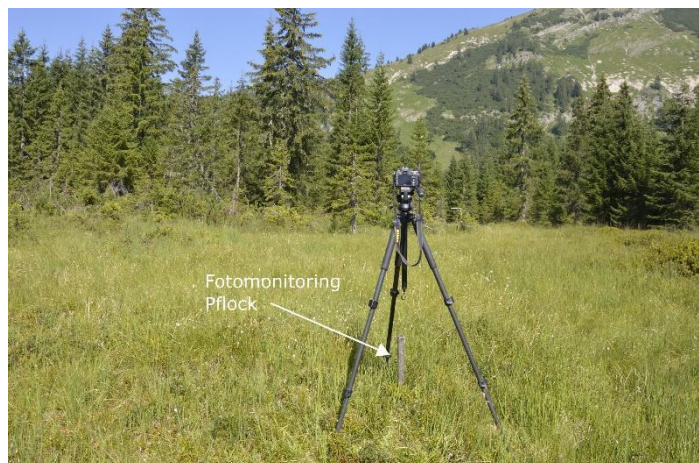
Abbildung 14: Auf diesem Foto ist die Methode des Fotomonitorings zu sehen. Die Kamera wird mit einem Stativ über dem Pflock platziert. Bildnachweis: Magdalena Haidegger
